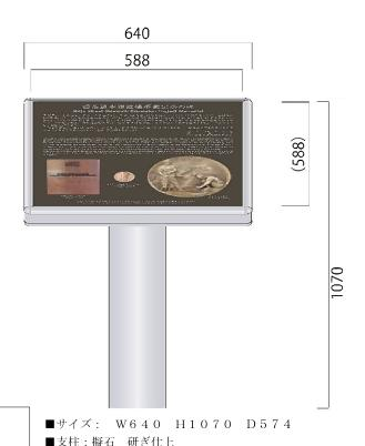
■フレーム: アルミ押出形材 合成樹脂焼付塗装 (ライトグレー)
